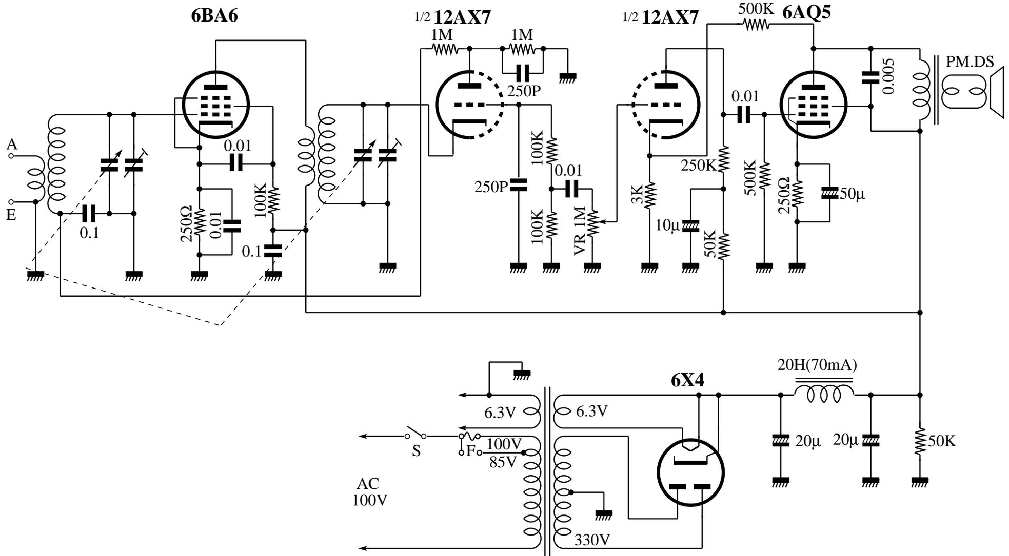
音質本位に設計されたラジオ。12AX7の半分のカソード・グリッド間で二極管検波を行っているが、カソード・プレート間でも若干の検波電圧がえられるので、その電圧をAVCに利用している。
