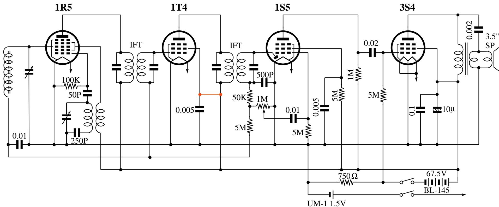
注意：原図には1T4の $G_2$ はB電源に接続されていないが、恐らく赤線のように結線されていると思われる
