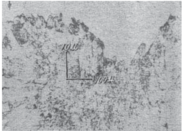
第2図 銅と鋼の摩擦による銅の破損 (縦の長さは横の長さの10倍にしてある)
